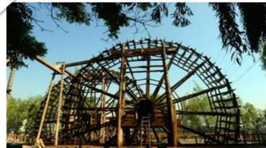
与南方龙骨水车不同，兰州水车酷似巨大的古式车轮，轮幅半径大的将近10米，小的也有5米。水车完全以木作成，且为榫卯结构。兰州水车制造工艺已列入第一批国家非物质文化遗产保护目录。
